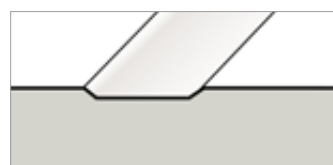
Nordic – Querschnitt Türblatt mit vertieften Profilen
